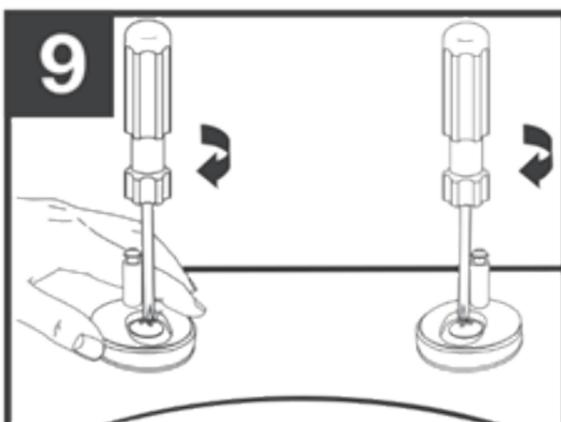
Sostener y ajustar firmemente los pernos de fijación.
