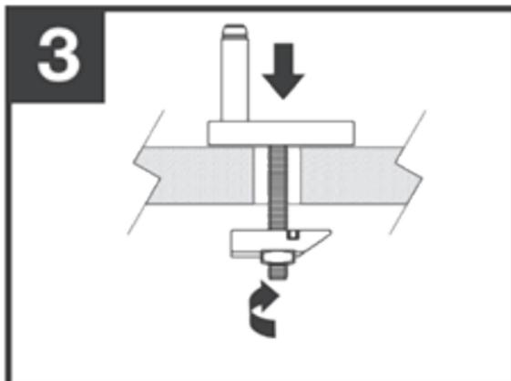
Ubicar la traba del soporte en posición horizontal coincidiendo el encastre con la tuerca provista.
