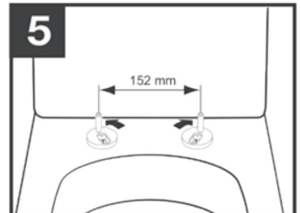
Se sugiere posicionar los pernos hacia atrás y a una distancia de separación entre centros de 152 mm.
