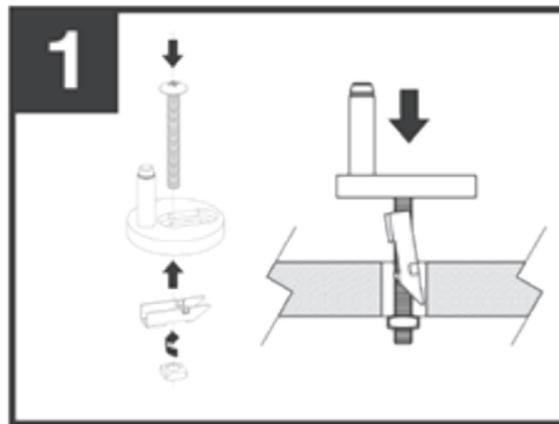
Insertar el soporte de la bisagra, pasando el tornillo a través del agujero del inodoro dejando la traba del soporte en la parte inferior.
