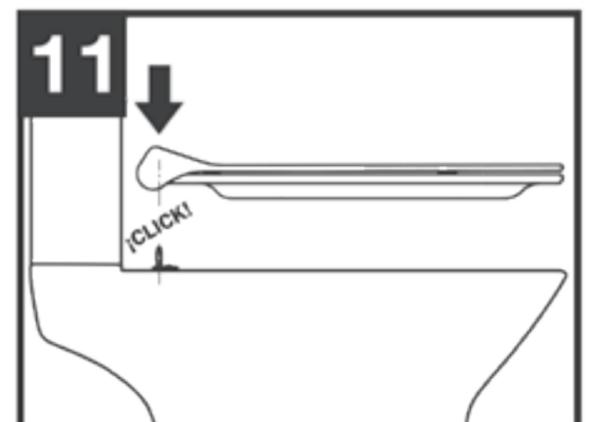
Insertar la tapa asiento en los pernos de los soportes hasta asegurar su fijación.
